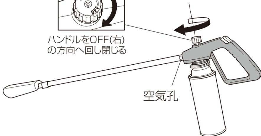
2.完全に消火した後、ボンベを取り外し作業を完了します。
