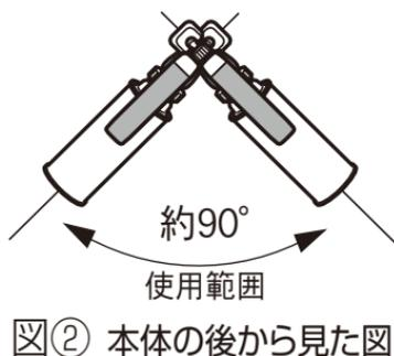
生ガスが出たときはハンドルを閉じ完全に消火したのを確認後、火口を使用範囲の角度で下向きにし、しばらくたってからもう一度ハンドルを開け点火してください。
