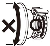
容器(ボンベ)の取り付け、取り外しは必ずボンベホルダーを回して行ってください。容器(ボンベ)を無理に回して取り付けたり取り外したりすると容器(ボンベ)位置決め金具が破損するおそれがありますのでおやめください。
