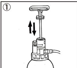
タンクを地面に置き、タンクに加圧されていない状態からポンプを3~5回押し圧力を加えます。
