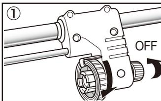
周囲に火気などのないことを確認します。予熱バーナーハンドルをOFFの方向へ回し、完全に閉じていることを確認します。ボンベホルダーをOPEN(右)の方向へ止まるまで回します。
