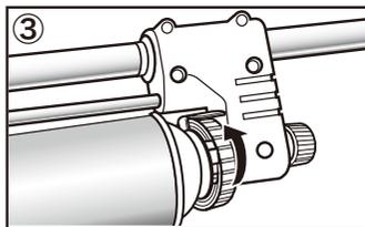
ボンベホルダーをCLOSE(左)の方向へ止まるまで回し、容器(ボンベ)を固定します。
