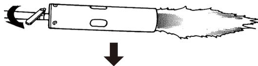
生火(灯油が気化されずに液体のまま噴射し赤く燃え上がる)ことが出来ないことを確かめてからタンクを地面に置き、初期加圧(ポンピング)としてポンプを約20回ゆっくりと押しタンクに圧力を加えます。
