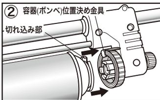
容器(ボンベ)の切れ込み部に容器(ボンベ)位置決め金具が入るよう容器(ボンベ)のカップをボンベホルダーの三つ爪に押し込みます。
