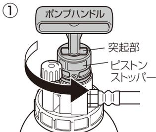
図の突起部と凹部を合わせ、ポンプハンドルを左方向へ約4回転半させ、ピストンストッパーのネジが外れるまで回します。
