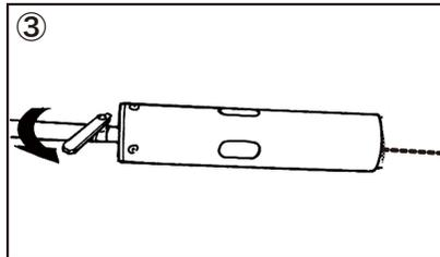
燃料開閉レバーを開きノズルから灯油を少し出します。レバーはその後閉じます。
