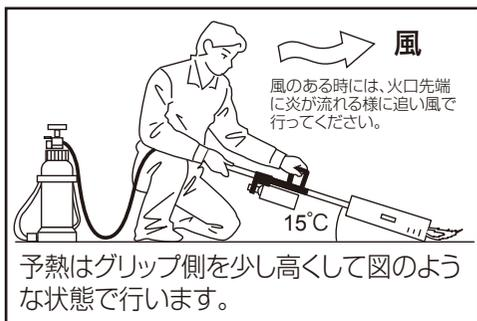
火炎が噴射して炎が大きくなるのは、気化器(予熱パイプ)の中の灯油が気化され膨張し、ノズルから噴射するためです。
