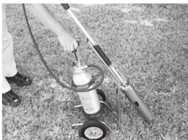
ポンプを3~5回押し、タンクに圧力を加えます。
