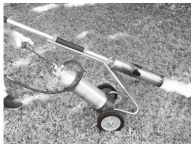
予熱完了後、燃料開閉レバーを開き、ポンプを約20回ゆっくりと押しタンクに圧力を加えます。
