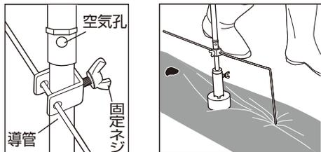
マルチシートに穴を開けると同時に、ゲージで次に開ける穴の位置に印を付けます。
