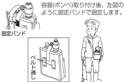
容器(ボンベ)収納ケースは図のように、肩からたすき掛けにして使用する方法と、ベルトに通して使用する2通りの使用方法ができます。
