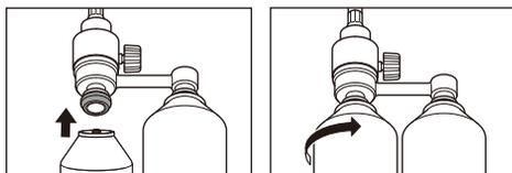
※容器(ボンベ) 1本のみでも使用できますが、長時間の連続使用で火力が弱くなる場合があります。できるだけ容器(ボンベ)は2本取り付け使用してください。
