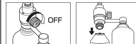
ハンドルをOFFの方向(ハンドルの上から見て右回り)に止まるまで回して消火します。完全に消火したことを確認後容器(ボンベ)を取り外し作業を完了します。
