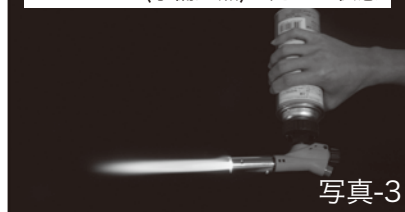
プレヒート(予備加熱)が完全な状態
