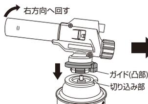
3. 容器(ボンベ)の切り込み部にガイド(凸部)を合わせ、本体を下へ押し付けながら右方向に止まるまで約60度回します。
